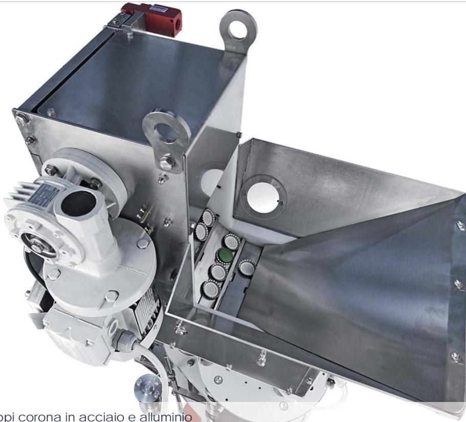
Orientatore per tappi corona in acciaio e alluminio
