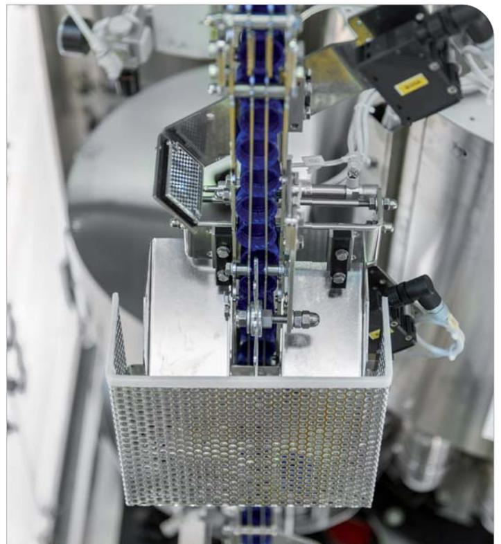
Espulsore automatico capsule rovesciate (A.E.D.)
