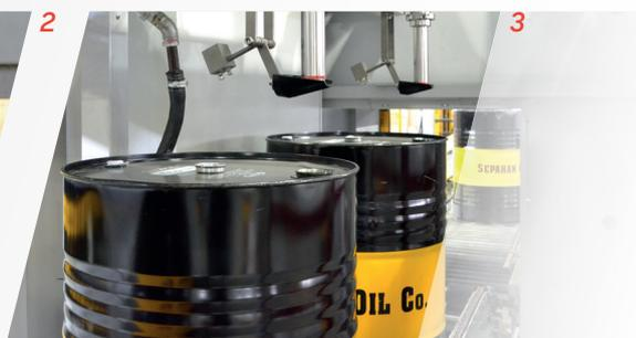
La gamma Libra comprende una categoria di macchine modulari per il riempimento in linea di contenitori di grandi dimensioni in plastica o metallo.
