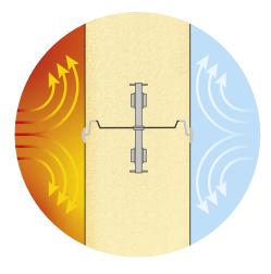
Nella sezione si nota come il giunto a secco permetta il passaggio dell'aria, mentre il giunto a gancio MFG di Cosma Impianti garantisce l'impermeabilità all'aria grazie alle sue caratteristiche costruttive:
