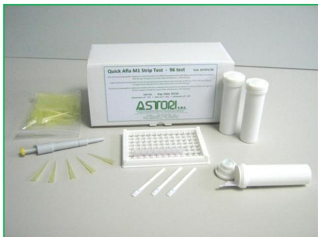
Il kit Quick Afla M1 Strip Test permette la determinazione qualitativa/semiquantitativa rapida (**10 minuti**) dell'Aflatossina M1 nel latte.
