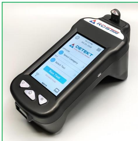
Il kit Quick Afla M1 Strip Test combinato al lettore portatile di strisce-test RDS-2500 fornisce risultati quantitativi in soli 10 minuti nell'ambito compreso tra 10 e 350 ppt circa di Aflatossina M1 nel latte.
