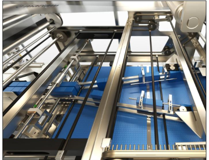
Le confezioni, durante la fase iniziale, vengono avvolte nel film prima di entrare nel tunnel di termoretrazione, dal quale escono sotto forma di fardello stabile e ben avvolto. Il singolo multipack viene formato grazie ad un'unità taglia/cuci che garantisce la perfetta chiusura del film.
