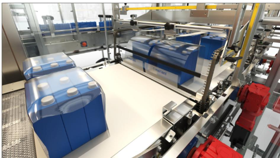
La macchina impiega un concetto di design collaudato all'ingresso per la movimentazione del prodotto e la formazione di fardelli, producendo pacchi quadrati strettamente avvolti che garantiscono l'integrità dei cartoni e una manipolazione sicura. La stazione di avvolgimento del film funziona in modalità continua senza barra saldante ed il film viene sigillato sotto il nastro.
