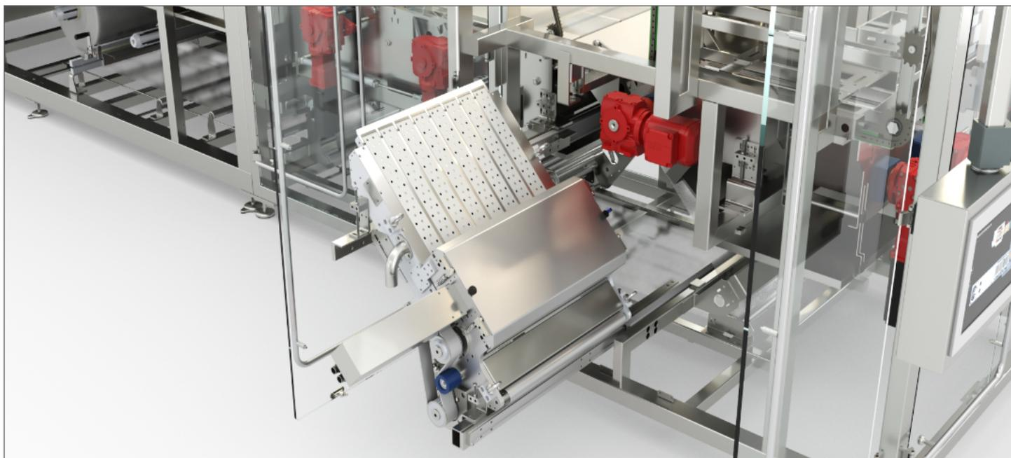
**Sistema di svolgimento/taglio film completamente estraibile per semplificare le operazioni di manutenzione**
