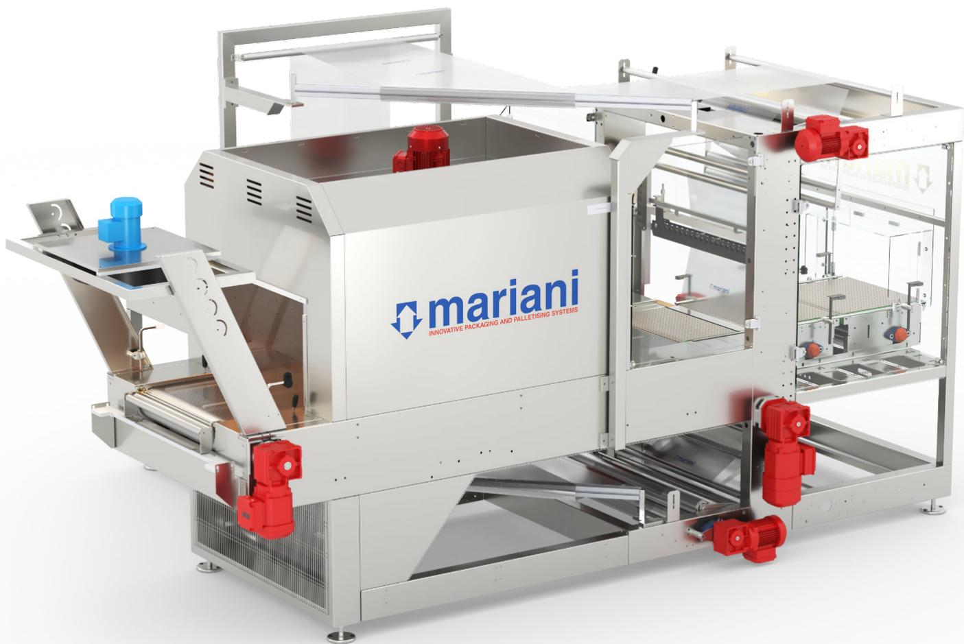
Il film viene sigillato mediante barra saldante con resistenza incorporata e quindi tagliato con una lama a freddo.
