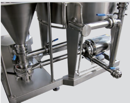
Pompa di rilancio.
